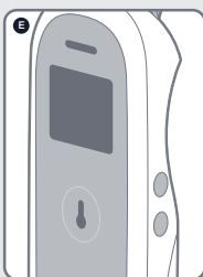
E. Tekan tombol Ukur untuk mengukur suhu
